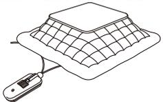
こたつ出入りの際に引っ掛けるなどして、断線やショートを引き起こし、火災や感電、故障の原因になります。If the switch gets caught when moving it inside or outside of the futon, it may result in severed wires or short-circuits and cause fires, electric shocks or malfunctions. 会在进出被炉时勾挂到等，导致断线或短路，从而引发火灾、触电或故障。
