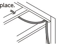
電源コードを固定せずに使用すると、断線やショートを引き起こし、火災や感電、故障の原因になります。
