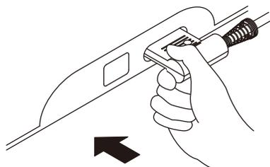
※器具用プラグを逆に差し込んでしまったり、斜めになった状態で差し込んでしまうと、器具用プラグ、器具用プラグ受けが破損、変形する恐れがあります。
