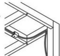
電源コードを固定せずに使用すると、断線やショートを引き起こし、火災や感電、故障の原因になります。
