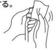
電源プラグにホコリが付着し湿気を吸収しトラッキング現象により、火災や感電の原因になります。電源プラグを抜き、乾いた布で拭いてください。
